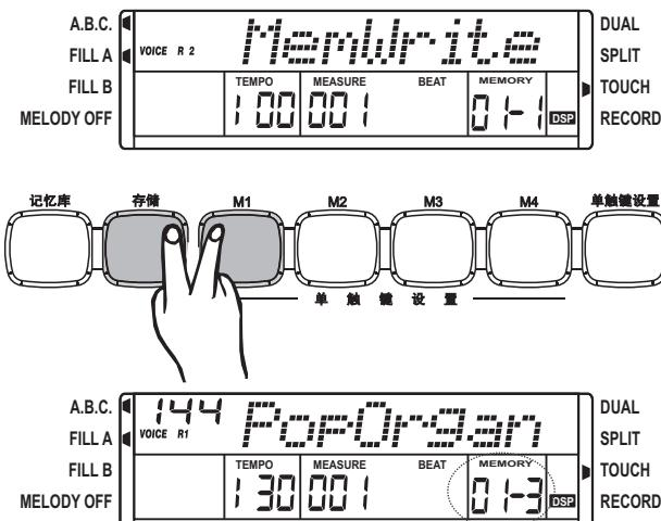
2、这时，您只要按下存储记忆状态M1~M4任意1钮，则存入该存储记忆状态的数据将被调用取代当前状态，LCD液晶显示屏的“MEMORY”处显示当前存储记忆状态序号。
