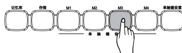
3、同时按住[存储]+[M1]钮不放，再开机，此时所有存储记忆状态内容都将恢复到出厂设值状态。
