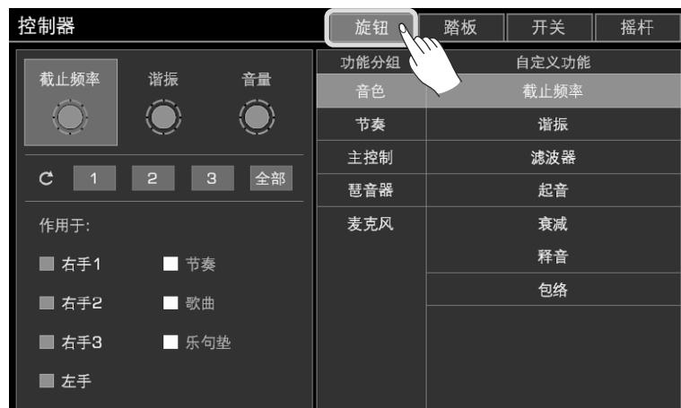
2. 点击选择一个旋钮。此时，您能在界面的右侧看到该旋钮当前被设置的功能。点击功能分组切换旋钮功能分组，点击功能名称选择自定义旋钮功能。
