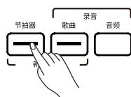
3. 点击界面上的“停止”按钮或按下面板上的 [启动/停止] 按钮结束录音。如果您在录制时使用了节奏，那么当节奏的尾奏段落播放完毕后，录音也会随之停止。
