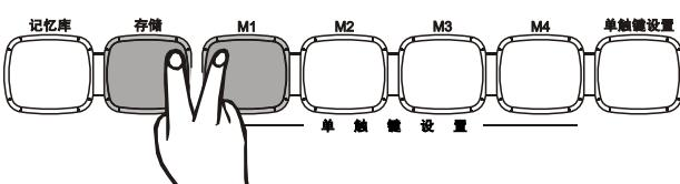
3、同时按住[存储]+[M1]钮不放，再开机，此时所有存储记忆状态内容都将恢复到出厂设值状态。
