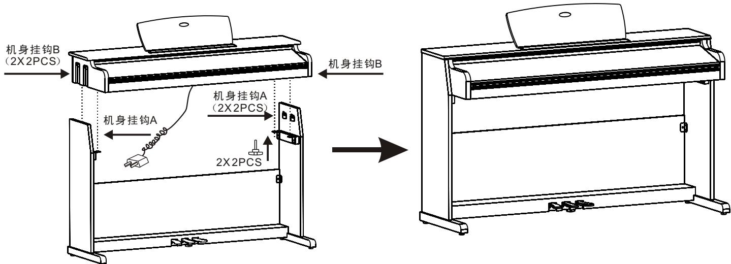
D) 基本装嵌完成后, 将电线固定扣分别贴在左、右琴腿上, 用于固定电源线及脚踏线; 将脚踏线插入琴体底部踏板插孔中; 调整脚踏盒底部的脚踏手扳螺丝接触地面, 使其与左、右琴腿平衡, 然后接通电源, 即可开机。
