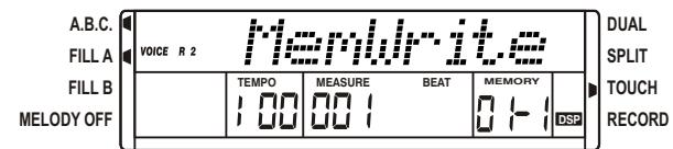
2、这时，您只要按下存储记忆状态M1~M4任意1钮，则存入该存储记忆状态的数据将被调用取代当前状态，LCD液晶显示屏的“MEMORY”处显示当前存储记忆状态序号。
