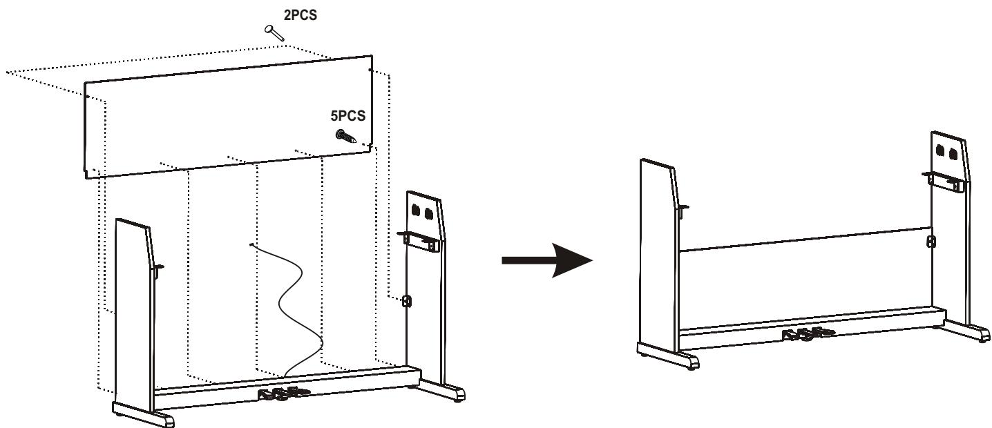
C) 将琴体放在已完成的步骤B)上, 琴体左右两边的机身挂钩B分别插入左、右琴腿架对应的挂钩A上, 用四颗手扳螺丝对准孔位, 拧紧。
