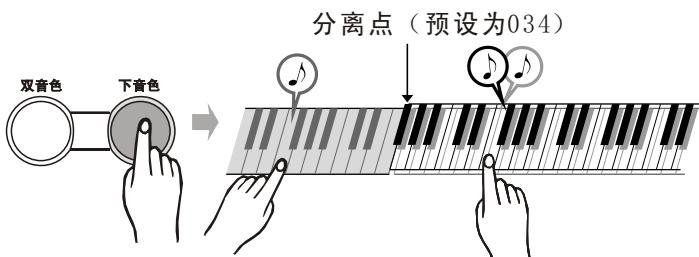
1、按[下音色]钮，显示屏上“VOICE L”标志点亮，右侧状态光标指向“SPLIT”，LCD显示当前下音色名称和编号，表示进入下音色状态。
